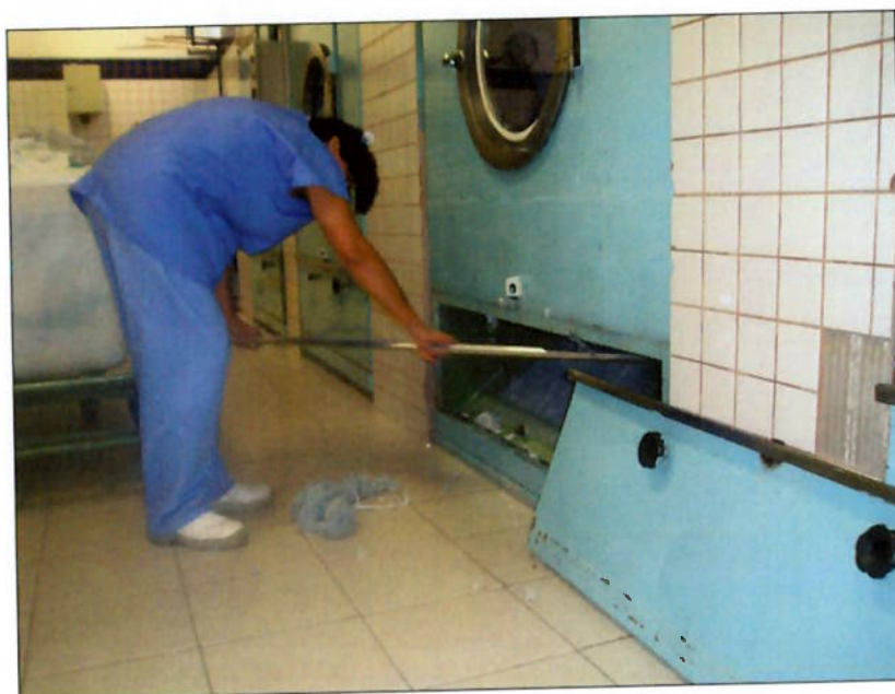
Figura 16. Limpeza do filtro de saída da secadora
