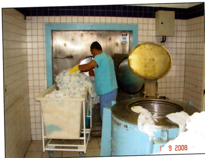
Figura 12. Retirada da roupa limpa da lavadora
