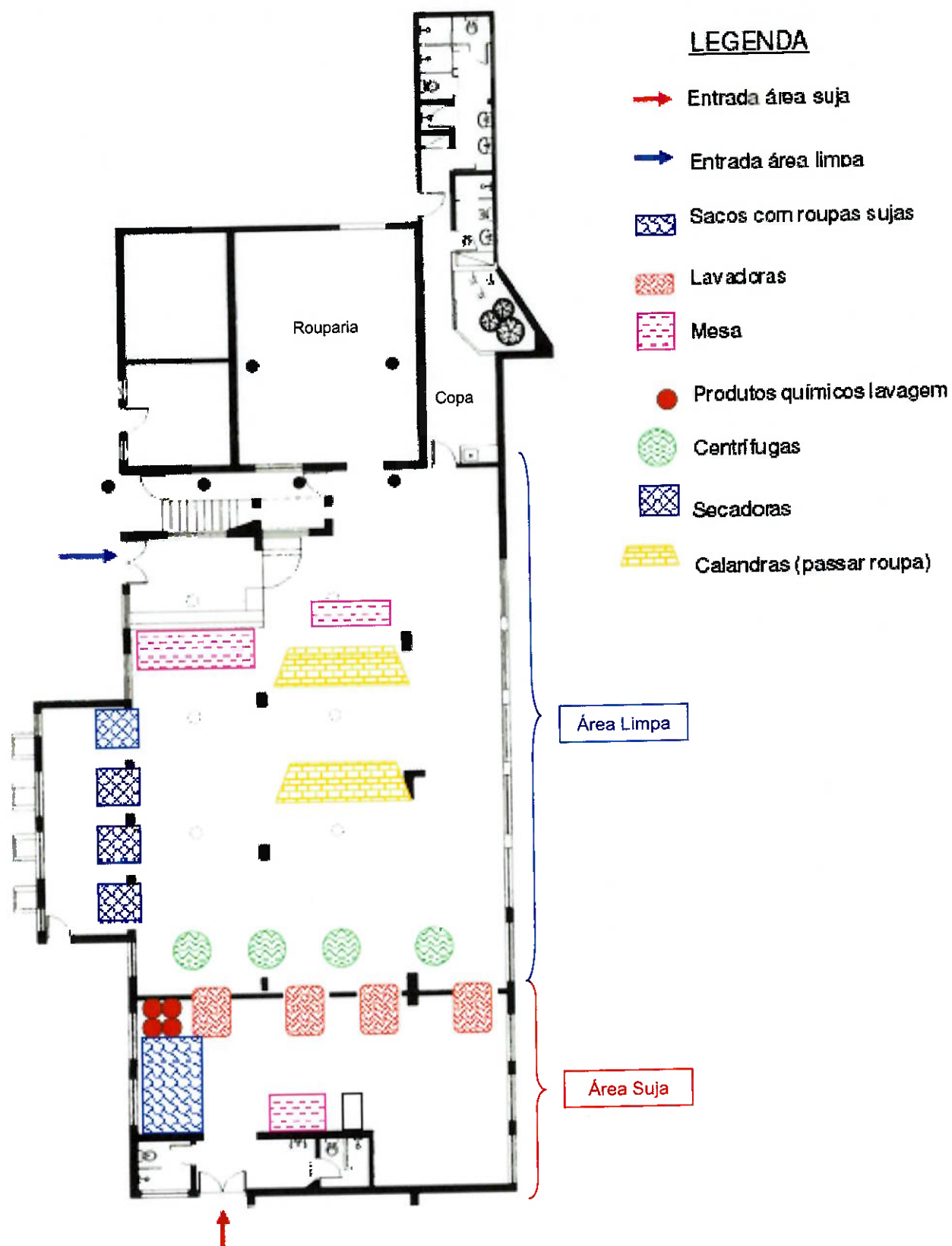
Figura 2. Planta da área da lavanderia (áreas suja e limpa – equipamentos)
