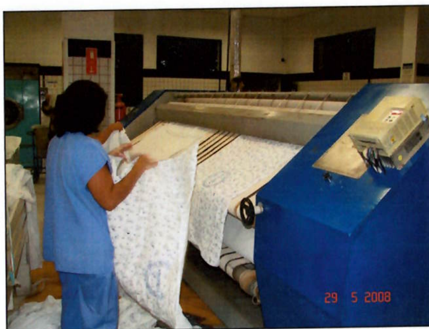
Figura 17. Abrir, esticar e colocar as roupas na esteira da calandra
