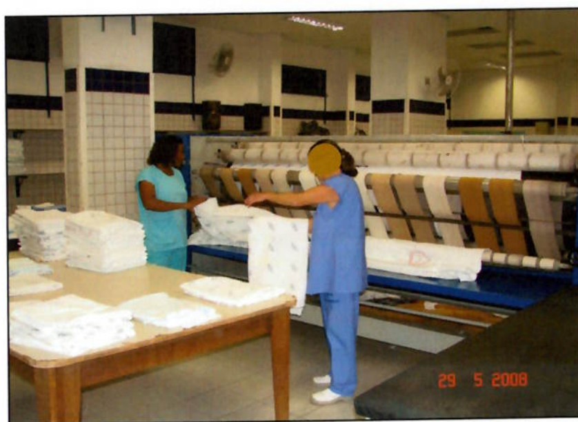
Figura 18. Retirada e dobra das roupas calandradas
