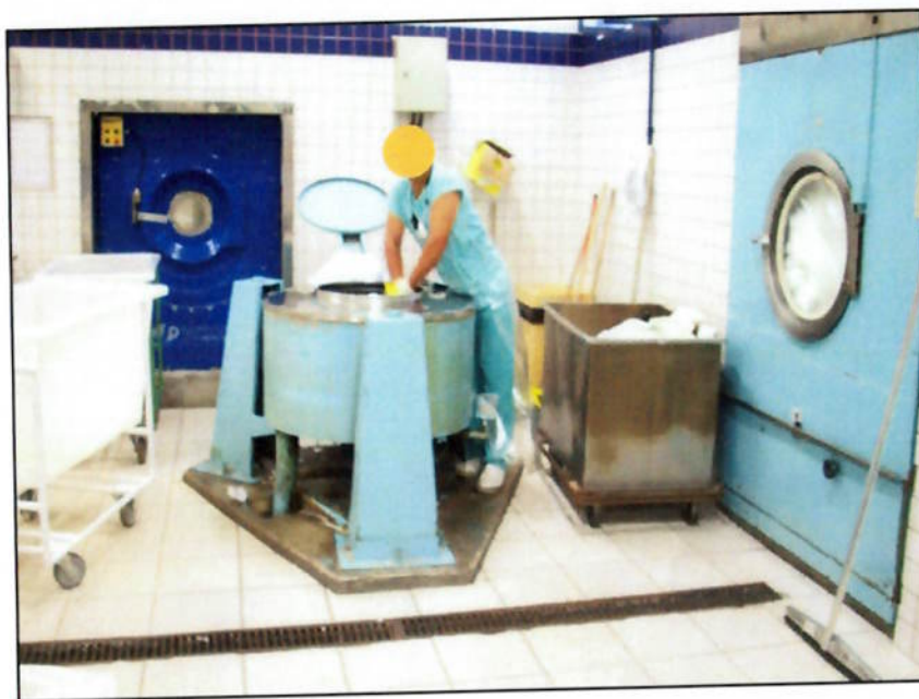
Figura 13. Colocação das roupas limpas na centrífuga
